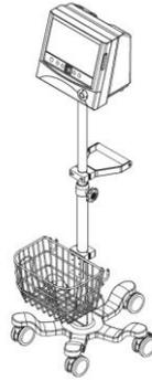
*Forme de montage de l'appareil sur le support*
