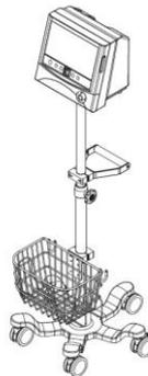
*Forme de montage de l'appareil sur le support*
